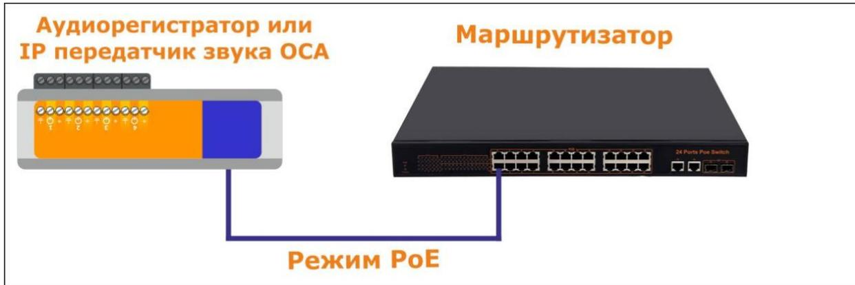
Схема подключения к маршрутизатору без поддержки PoE
