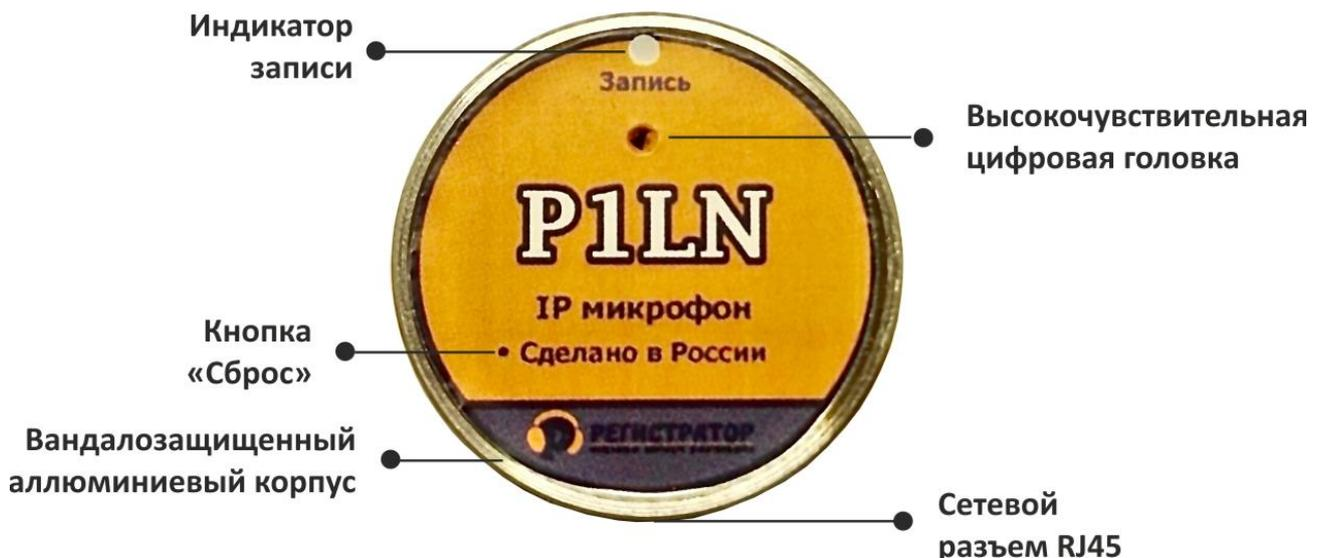
В моделях IP микрофонов ОСА P1LN и P1DL с металлической сеткой, кнопка сброс перенесена на торец корпуса, справа от сетевого разъема.
